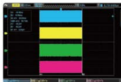
1 高达每通道28Mpts存储深度, 用户能够捕获更长时间的信号, 不丢失波形细节
