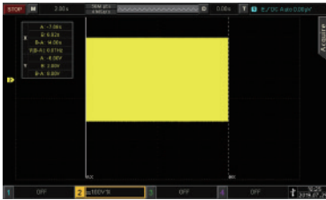
1 单通道56Mpts存储深度, 用户能够捕获更长时间的信号, 不丢失波形细节
